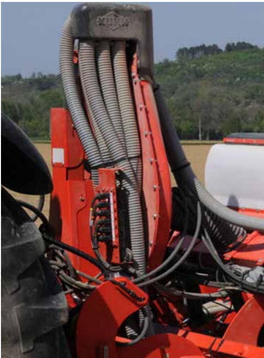
Slika 1. Creva koja usmeravaju vazdušnu struju bliže zemljištu
