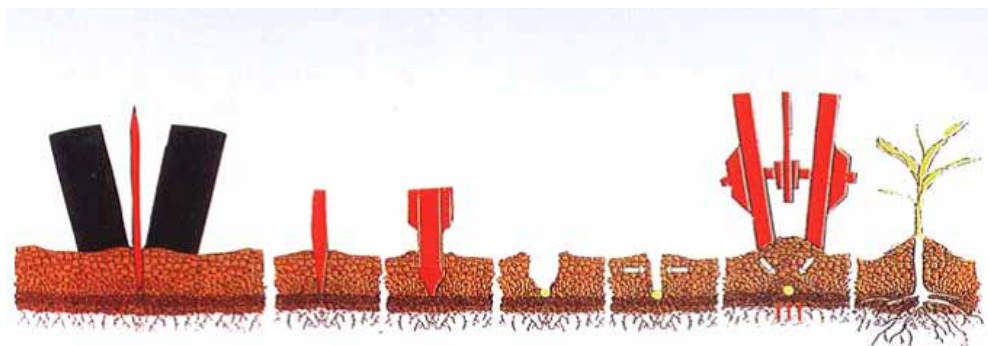
Slika 3. Šematski prikaz rada sejalice
